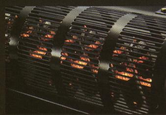
出力管に間接加熱方式のEL84、5極管を片側6本、計12本を配置。バラレルブッシュブルのA級動作として低歪率を達成しているのがポイント。また、フィードバックを使わずに、バラビチーニが拘り続けてきた“バランスプリッジモード”、超広域帯スペシャルオリジナル出力トランジスタを使用しているのも特徴だ。その結果、本当の意味でのビュアを実現。官能的なサウンドを勝かせる。
