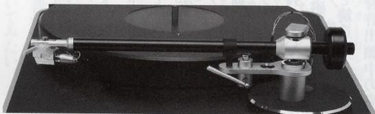
本機に付属するスタティックバランス型トーンアームVerify。軸受け部は、機械的接点を持たず、磁力を用いた独自の方法を採る。ワイアーの張力を調整することで、インサイドフォースの調整も可能である。
