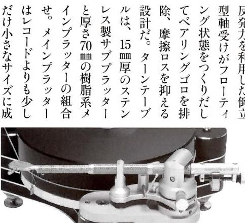
試聴に用いた別売りのトーンアームUniversal(¥650,000)。同社ラジアルトーンアームの最高峰で、アームパイプにはカーボン材を使用。調整のしやすいアームで、インサイドフォースの調整は磁力を用いて行なう。
