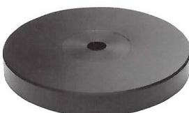
厚さ40mmのPOM(ポリオキシメチレン)製のメインプラッター。フライホイール効果を生むためにリム側に重量を持たせた構造で、アルミ製サブプラッターの上部に装着される。
