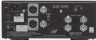
入力端子2系統を装備。MC／MM切替えスイッチをリアに配する。出力端子はRCAアンバランスとXLRバランスを装備し、スイッチで切り替える。
