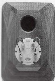
大きめのバスレフポートが開口するリアパネル。ポート周辺は丸みを持たせることで風切り音が抑えられている。入力端子はWBT社製Nextgen純銅ターミナルを使用。
