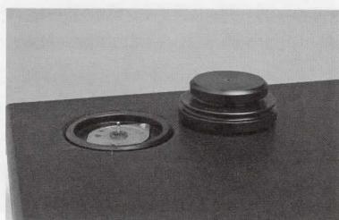
極小トルクの24極シンクロナスマーターの極めて細いモーターシャフトに、右側のブーリーを差し込む。ブーリーの溝と駆動ベルトが一直線になるよう、モーターユニットの高さを調整する
