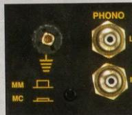
MM/MCはスイッチにて切り換えることが可能で、内蔵の昇圧トランジストによるMC対応が魅力だ
